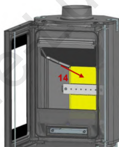
14 : Poser le réfractaire haut sur le dessus de la boîte à air et contre le fond.
