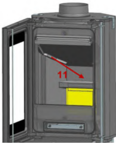
11: Poser le réfractaire bas sur la sole foyère et contre le fond
